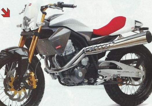
doble y grueso tubo desde la columna de dirección hasta la zona del eje del basculante. Éste es una formidable pieza de aluminio que sujetá un amortiguador colocado lateralmente (Pro Lateral Link), con sistema progresivo. Delante monta una horquilla invertida mul-
