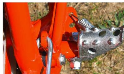
Varios detalles técnicos hacían especiales a las Simson. El más destacado, el disponer de válvula rotativa en la admisión. Otro detalle era el pedal de arranque a la izquierda y con accionamiento hacia delante.
