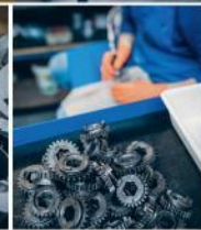
Ook de versnellingsbak tandwielen produceert TM zelf.
