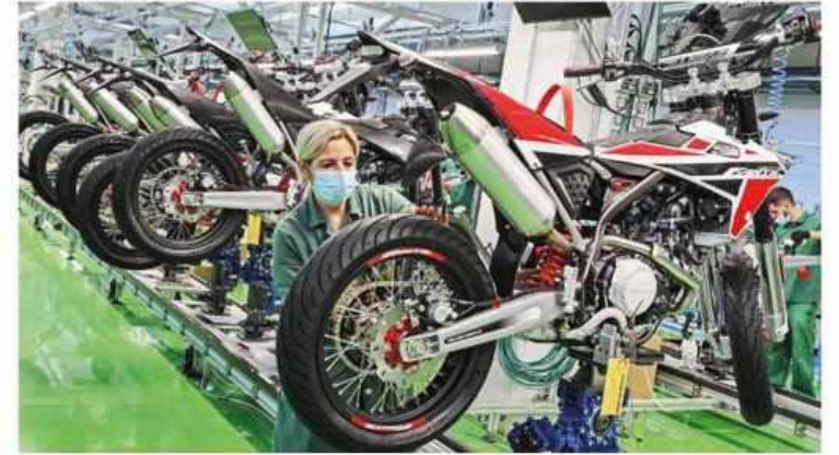
CHAÎNE - La ligne de montage de la Fantic XEF 125 Enduro et de la Fantic XMF 125 Motard avec le moteur Minarelli 125 4T de l'entreprise.
