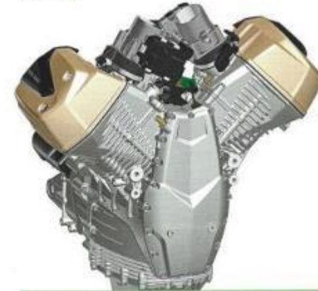
In der Vorderansicht werden die kompakte Bauweise und eine gewisse Ähnlichkeit mit dem klassischen Guzzi-Motor deutlich. Oben rechts die Kurbelwelle mit dem Primärzahnrad, die Kupplung läuft axial und ist über einen Rückläufer abgesichert. Unten rechts der kompakte wassergekühlte Zylinderkopf mit Ventilen in V-Anordnung und Vertikal durchströmung
