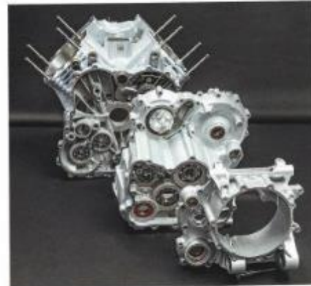
Die wichtigsten vertikal geteilten Baugruppen des Gehäuses: vorne das Kupplungsgehäuse mit Schwinge, Legierung, davor das Getriebe und das Kurbelgehäuse
