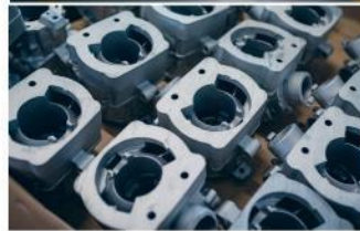
Ongeveer 80% van alle onderdelen worden in eigen huis gemaakt, hier de ruwe tweetak-cilinders.
