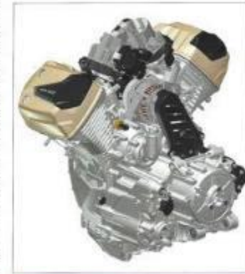
Zwischen den Zylindern läuft die von einem horizontalen angetriebene Lichtwelle. Rechts darunter die Wasserpumpe. Sekundärtrieb links ganz unten
