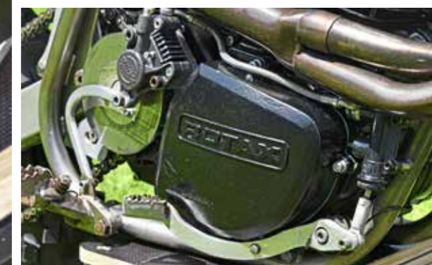
Clever: Der Fuß-Bremshebel ist zum besseren Schutz vorne angelenkt
