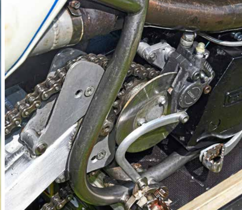
Ungewöhnlich: die beiden Umlenkrollen der „Anti-Tension-Kettenführung“ (ATK) an der Schwinge und die auf dem Ritzel angebrachte Scheibe der Hinterradbremse
