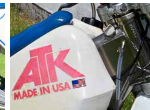
Vernickelt: der Rahmen mit integriertem Öltank und die simple Füllstandsanzeige
