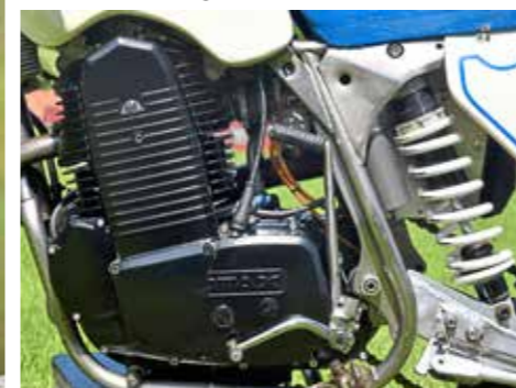
„Luftgekühlter Würfel“: Rotax-Single mit Zahnriemen-Cover auf der linken Seite
