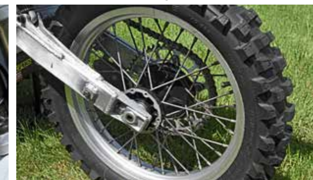
Leichtbau: Alu-Schwinge der ersten Modelle, keine Bremse direkt am Hinterrad
