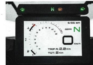
Ungewöhnlich: Die Kontrollleuchten sind etwas außerhalb des Blickwinkels oberhalb des TFT-Displays positioniert
