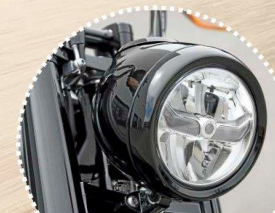
El faro circular con carcasa clásica en forma de bala es full led cuenta con luz de día y aloja la instrumentación en su cuerpo.
