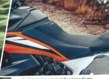
Die Sitzbank ist nun zweigeteilt und kann für den Fahrer auf 840 oder 860 mm Höhe positioniert werden. Toller Komfort und Bewegungsfreiheit
