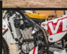
El motor es de Zongshen y usa un cárter similar al de la Fantic Caballero 500, pero con su propia unidad de combustión con dos árboles de levas en cabeza. Rinde 51 CV a 9.500 rpm.
