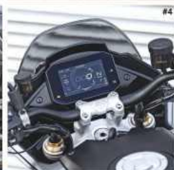
#1 La V100 reçoit des déflecteurs qui s'adaptent automatiquement à la vitesse. #2 Classique et moderne à la fois, la ligne ne manque pas de personnalité. #3 Si l'architecture du moteur n'a pas changé depuis des lustres, le refroidissement liquide et les nombreuses assistances électroniques sont fermement d'actualité. #4 L'instrumentation TFT provient du cousin Aprilia. #5 Les suspensions semi-actives sont l'un des apogées de cette version S.
