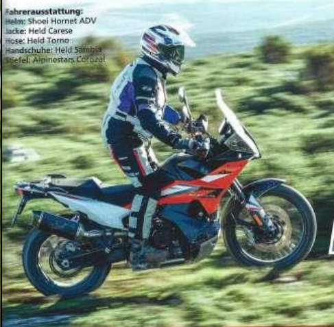
Die Sitzbank ist nun zweigeteilt und kann für den Fahrer auf 840 oder 860 mm Höhe positioniert werden. Toller Komfort und Bewegungsfreiheit
