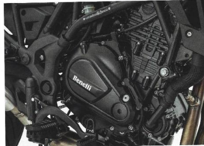
Der Zweizylindermotor der TRK 702 ist weder ein aufgebogener 500er, noch ein runtergebückter 800er. Er entstammt einer eigenen Motorenfamilie
