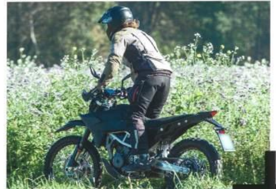
Am Prototyp der 390 Enduro gut sichtbar: die Bananenschwinge mit darunterliegendem Endschalldämpfer und die Lambda- und Temperatursensoren an der Auspuffanlage
