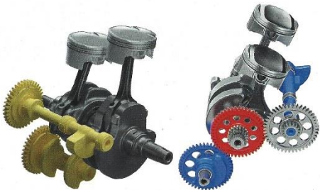
Beide Motoren vertrauen auf zwei Ausgleichswellen, links Suzuki in 90-Grad-Anordnung zur Kurbelwelle, rechts Honda. Beide Motoren mit 270-Grad-Kurbelwellenkrüpfung
